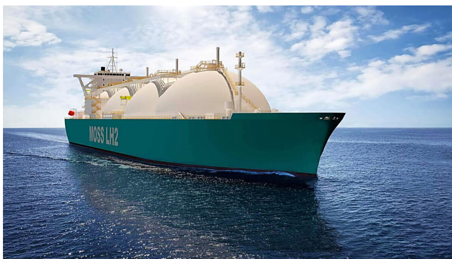
Figura 11: Navio de transporte de hidrogênio liquefeito com tanques esféricos criogênicos
