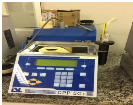
Figura 10: iSL CPP 5Gs® para determinação de ponto de fulgor
