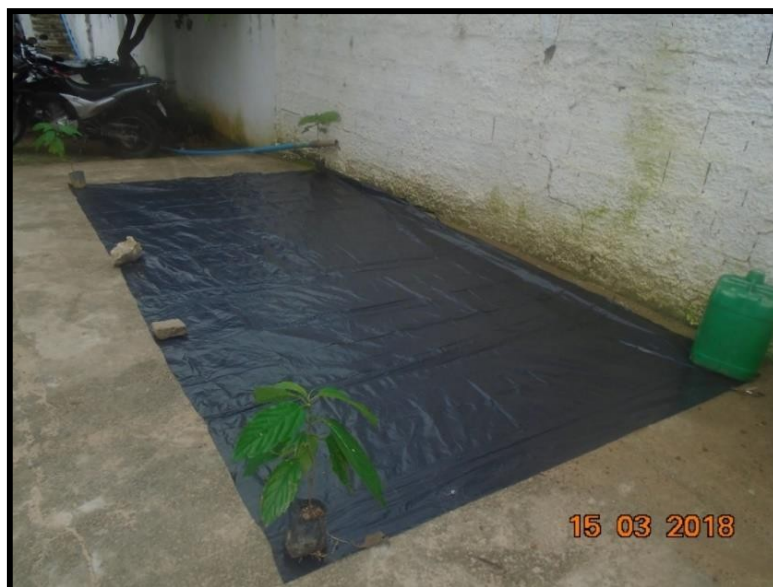
Figura 13 – Lona utilizada para a realização da composição gravimétrica dos resíduos.
