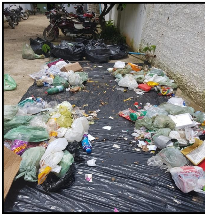
Figura 15 - Esquematização do Processo de Quarteamento de Resíduos Sólidos.
