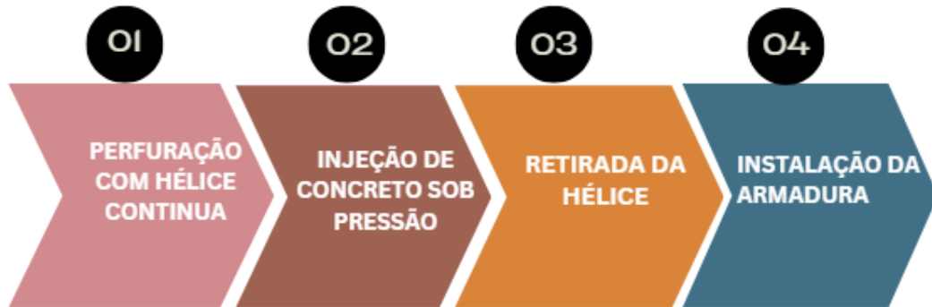
Figura 14 — Etapas Estacas Hélice Continua.
