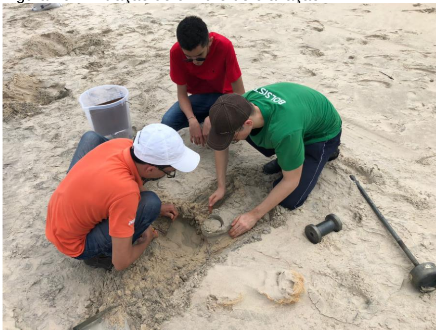
Figura 10 - Extração do cilindro de cravação
