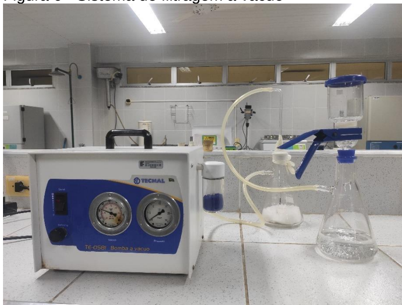
Figura 6 - Sistema de filtragem a vácuo
