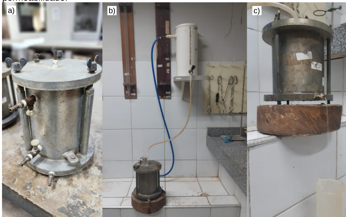
Figura 22 - Conjunto ensaio de permeabilidade. a) permeâmetro utilizado; b) conjunto de permeabilidade à carga constante; c) execução da determinação da permeabilidade.
