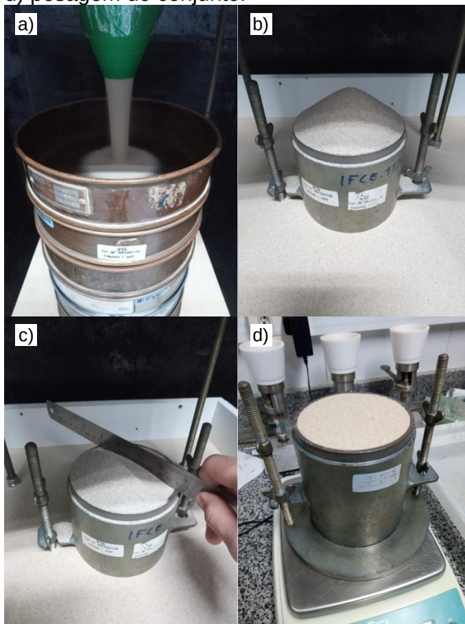
Figura 19 - Etapas do procedimento de pluviação. a) realização da pluviação; b) material pluviado; c) nivelamento da superfície; d) pesagem do conjunto.
