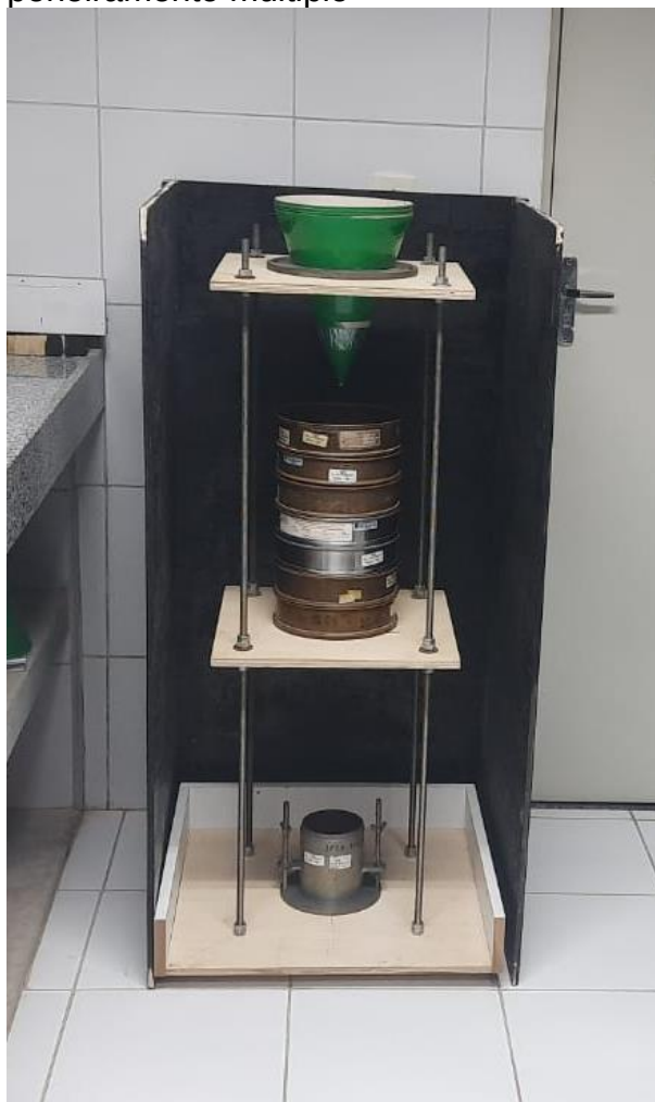
Figura 18 - Equipamento de pluviação com peneiramento múltiplo
