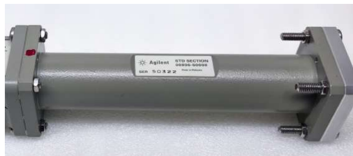
Figura 4 – Guia de ondas Agilent para medições de parâmetros de dispersão
