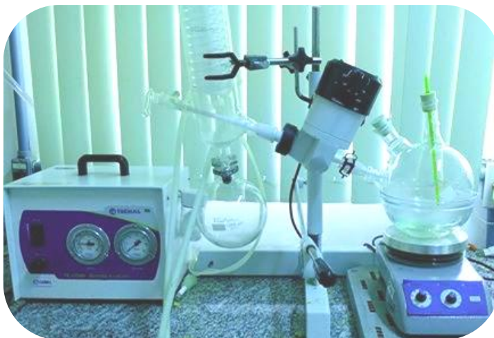
Figura 17 - Sistema montado para obtenção de óleo básico
