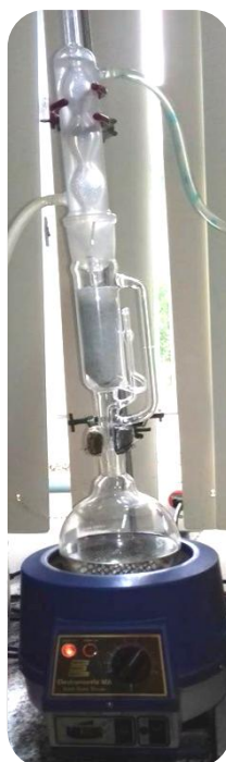
Figura 8 - Extração do óleo por sistema Soxhlet
