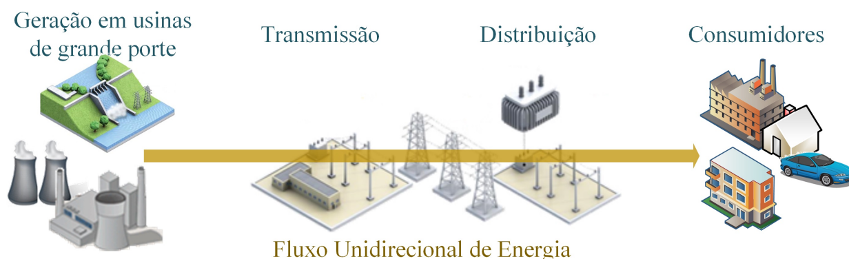
Figura 1 – Sistema elétrico de potência.
