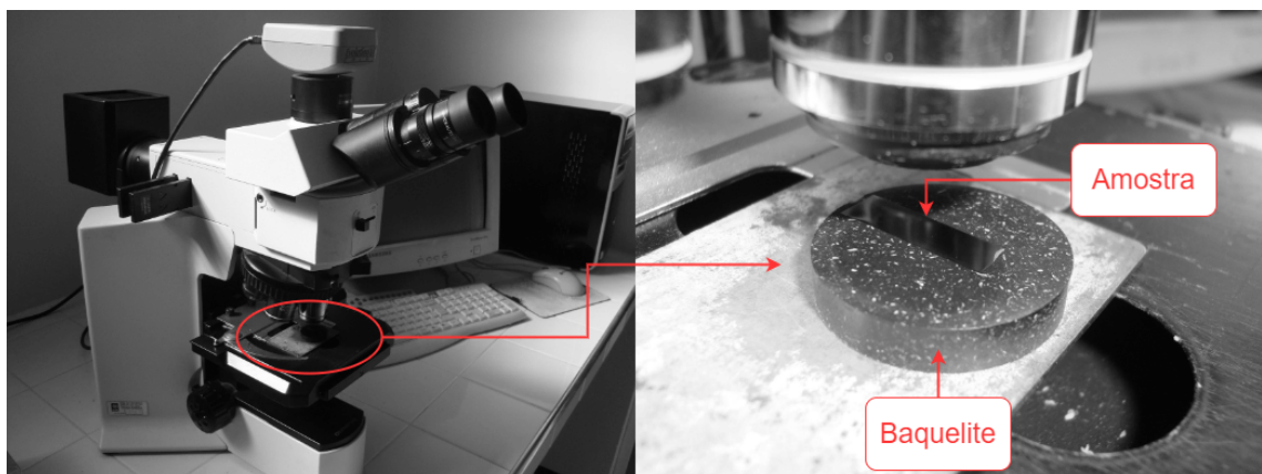
Figura 5 – Microscópio Óptico utilizado para aquisição das imagens digitais através da fotomicrografia, destacando o material de fixação e a amostra a ela acoplada.
