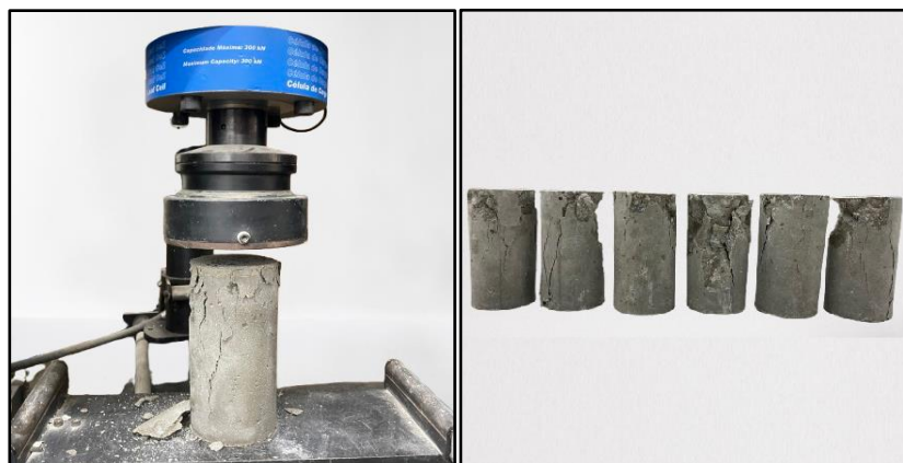
Figura 13 — CP em Rompimento - Resistência à Compressão
