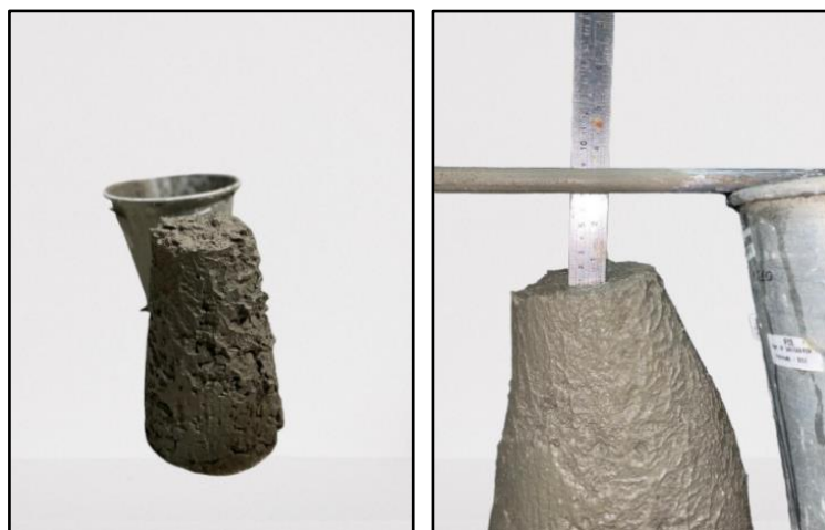
Figura 1 - Determinação da consistência ( slump test )
