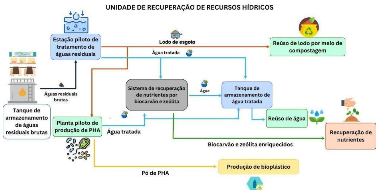
Figura 59 - Vista esquemática da instalação de recuperação de recursos hídricos da Universidade de Palermo
