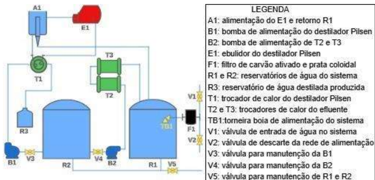
Figura 18 - Diagrama hidráulico do sistema de reúso de água
