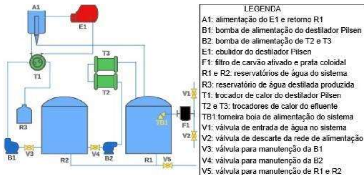
Figura 64 - Diagrama hidráulico do sistema de reúso de água
