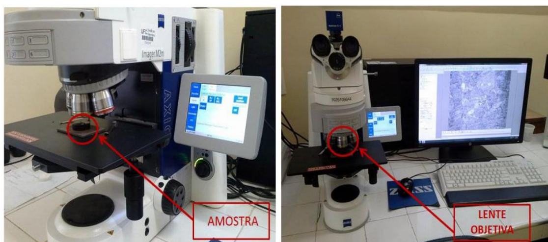
Figura 4.3. Configuração do procedimento de microscopia ótica para análise microestrutural do material em estudo.
