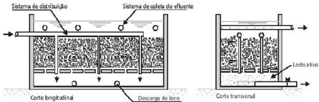
Figura 2 ï Esquema ilustrativo de um filtro anaeróbio.
