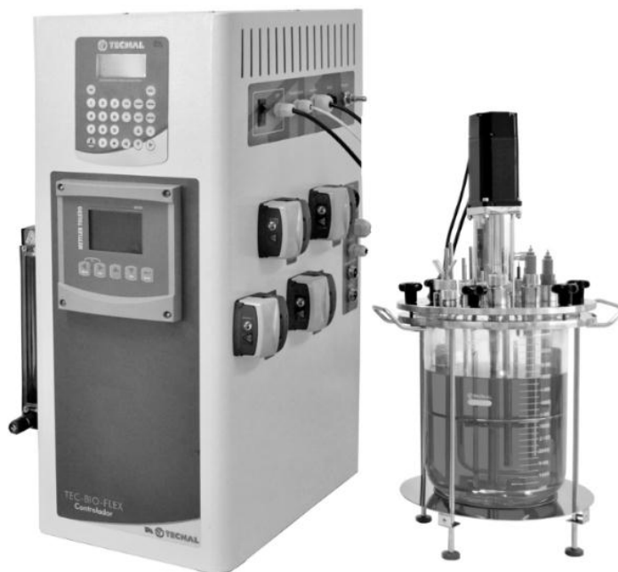
Figura 11i Reator TEC-BIO-FLEX usado nos ensaios cinéticos
