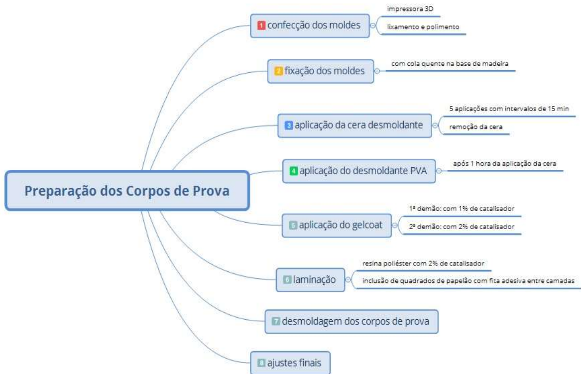
Figura 34 - Sequência de etapas para a confecção das amostras de GFRP
