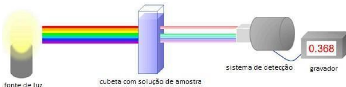
Figura 6: Princípio de medição em espectroscopia UV / VIS
