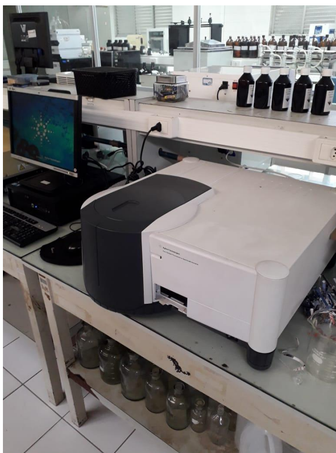
Figura 10: Equipamento Cary Eclipse
