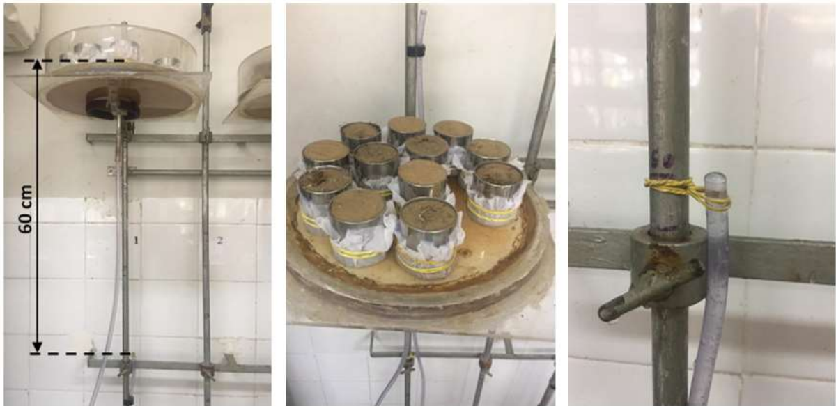
Figura 17 – Mesa de tensão submetida a um potencial de 0,6 mca (-6 kPa)
