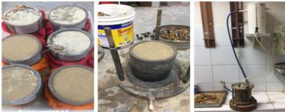
Figura 18 – Ensaio para obtenção da condutividade hidráulica saturada ( K_s ) pelo método do Permeâmetro à Carga Constante
