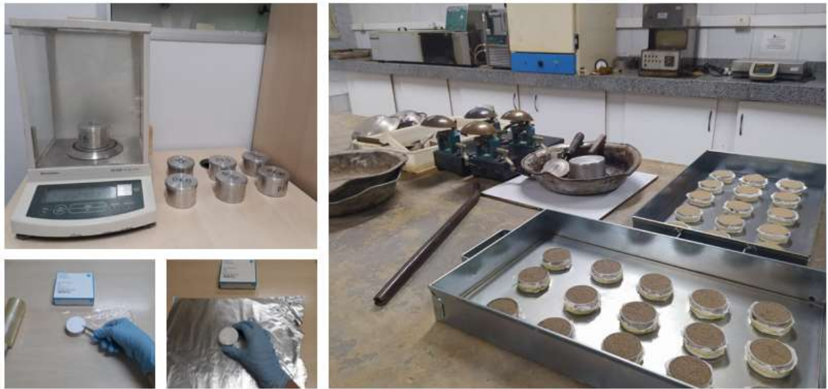
Figura 19 – Ensaio para obtenção da curva característica pelo método do Papel Filtro
