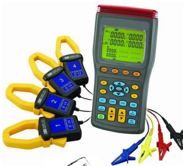
Figura 14 – Analisador de energia trifásico utilizado para armazenar e monitorar variáveis elétricas
