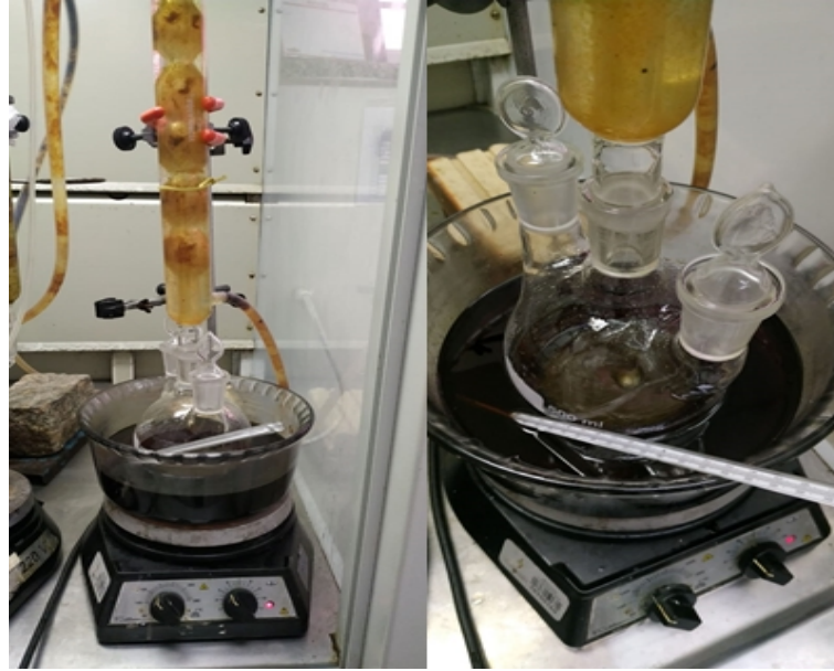
Figura 12 – Processo de Esterificação
