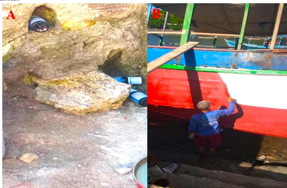
Figura 10 — (A) composto Barragem utilizado como agente biocida para potencializar a ação das tintas; (B) pescador realizando manutenção da pintura da embarcação no leito do rio, com composto biocida misturado a tinta.
