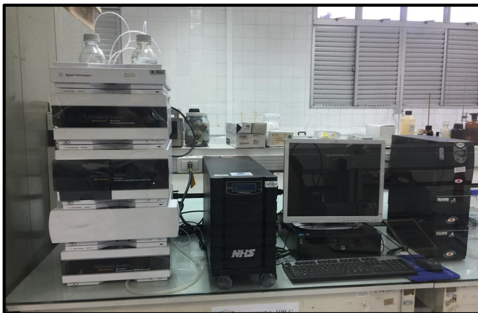
Figura 4.2 – Cromatógrafo líquido utilizado na detecção dos compostos.
