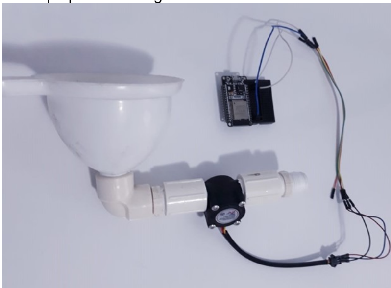
Figura 32 - Protótipo para Calibragem dos Sensores.
