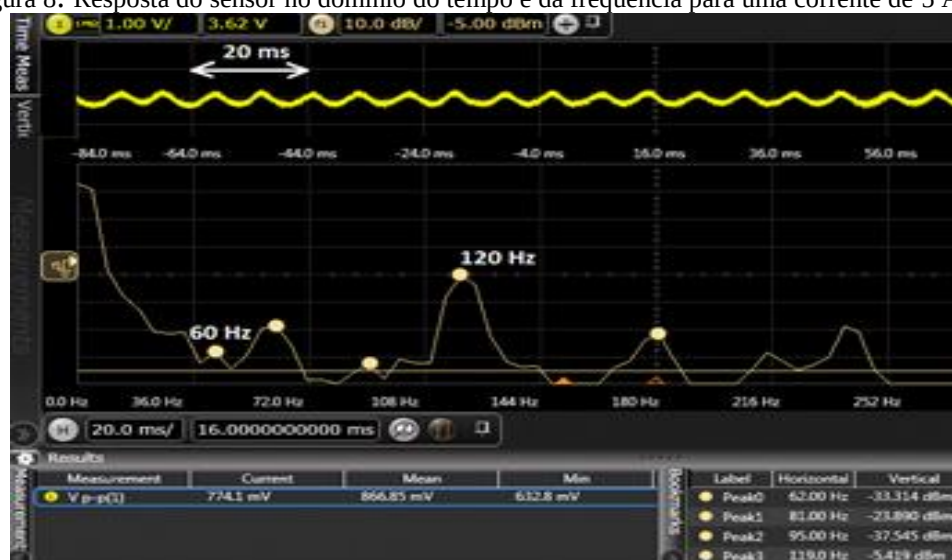
Figura 8: Resposta do sensor no domínio do tempo e da frequência para uma corrente de 5 A e 5 cm.
