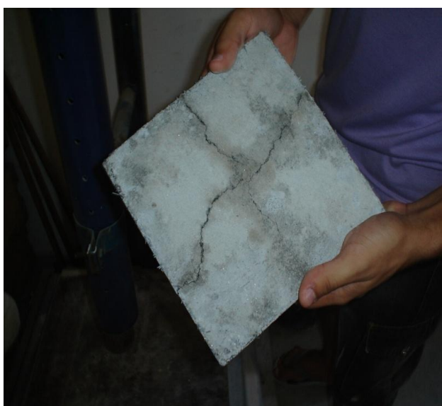
Figura 8 – Ilustração de uma típica placa fraturada durante o ensaio de impacto de corpo rígido. Fonte: Autor (2012).
