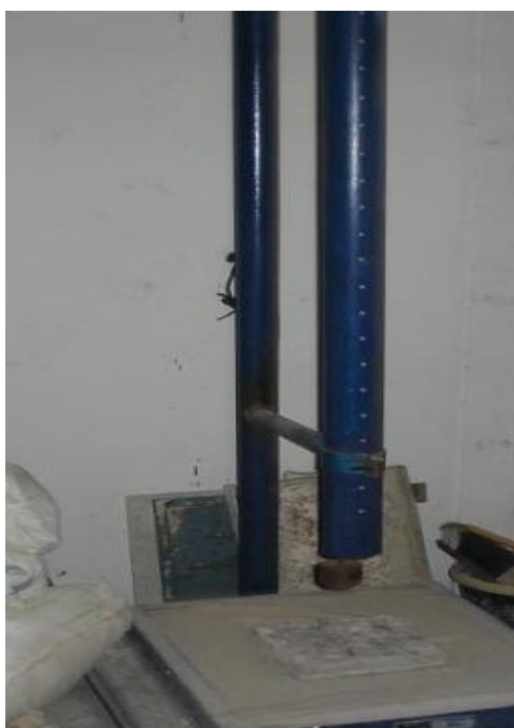
Figura 7 - Equipamento empregado na realização do ensaio de impacto de corpo rígido. Fonte: Autor (2012).
