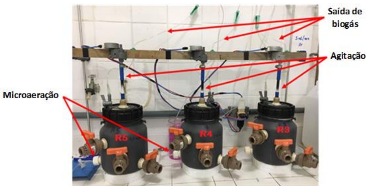
Figura 11 - Reatores anaeróbios e microaeróbios semicontínuos (Experimento II e III)
