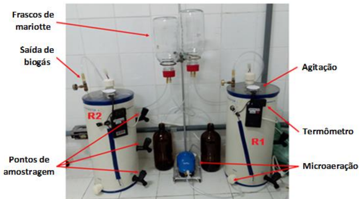
Figura 8 - Reatores anaeróbios em batelada (Experimento 1)
