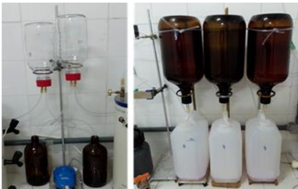
Figura 13 - Sistemas de medição de biogás utilizado nos experimentos I, II e III
