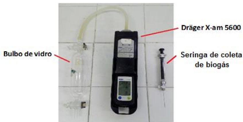
Figura 16 - Equipamento de medição de \text{NH}_3 e \text{H}_2\text{S}
