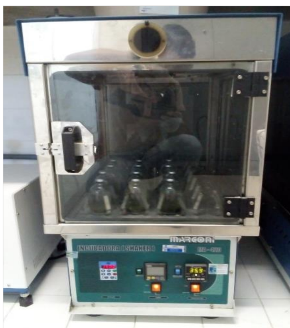
Figura 5 - Shaker orbital utilizado no teste de AME
