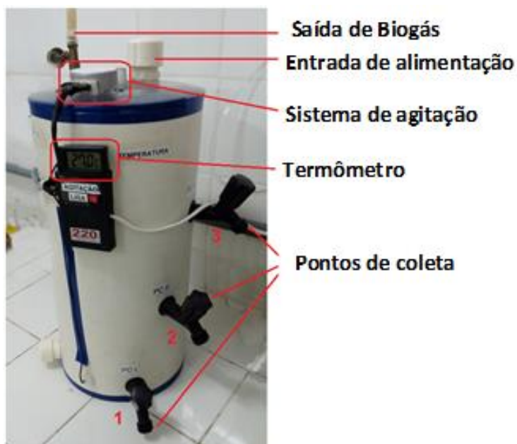
Figura 7 - Biorreator anaeróbio em batelada
