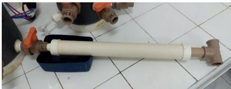
Figura 10 - Seringa usada na alimentação dos reatores semicontínuo
