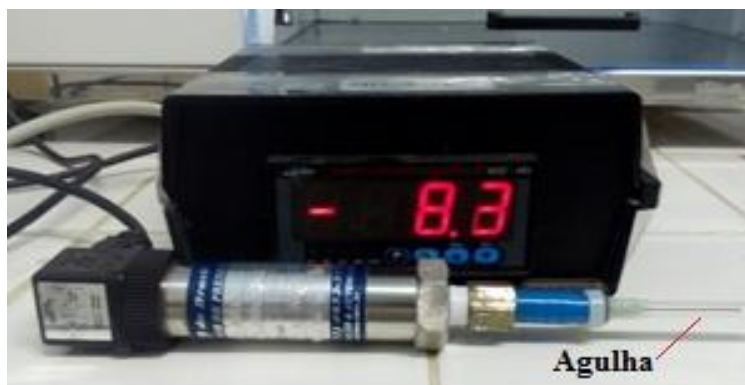
Figura 6 - Manômetro digital em mbar
