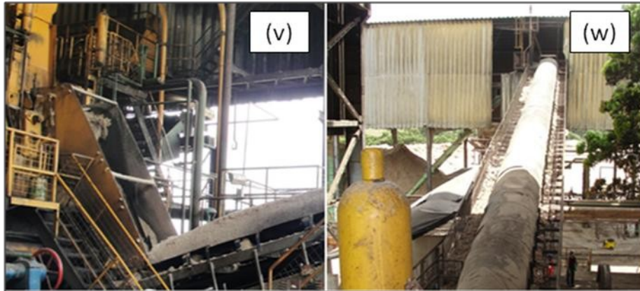
Figura 24 – Quarta esteira intermediária com bagaço (v) e tapete (w).
