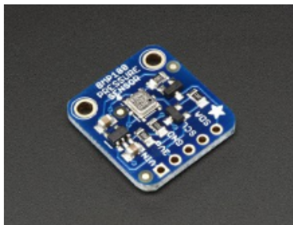
Figura 15 – Sensor BMP180 utilizado no projeto.
