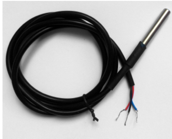
Figura 14 – DS18B20 encapsulado e impermeável.
