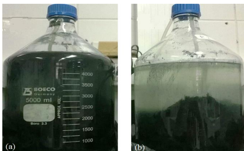
Figura 5. Reatores em bateladas sequenciais, dispostos em série, contendo biomassa imobilizada de Aspergillus niger AN 400, sendo (a) reator R1 e (b) reator R2.
