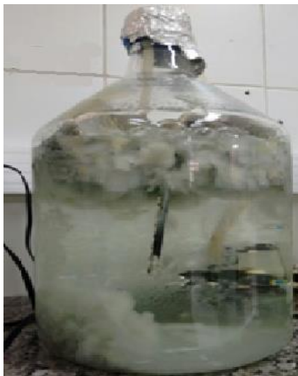
Figura 4. Fungos imobilizados no material suporte no interior dos reatores.
