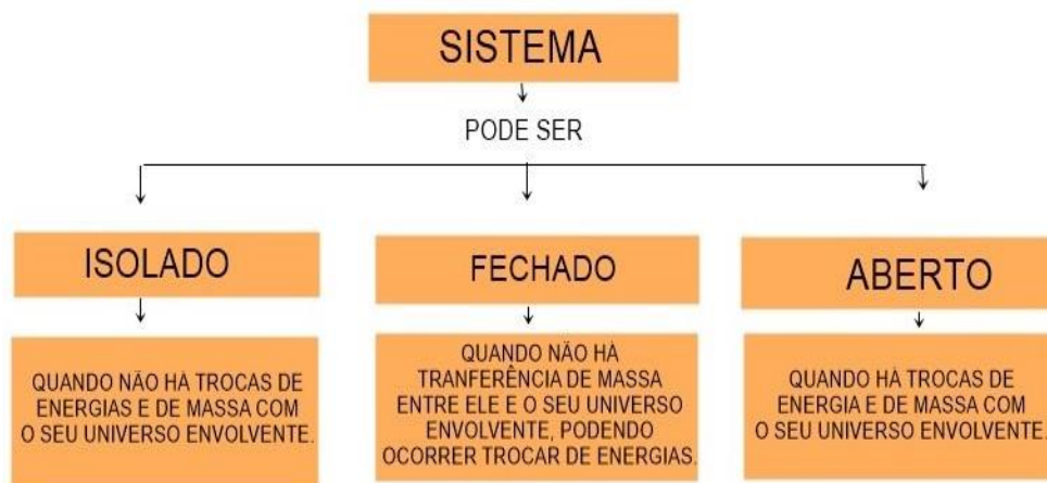
Figura 4 - Esquema explicativo dos tipos de sistemas: isolado, fechado e aberto
