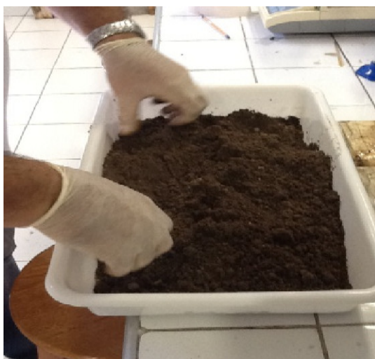
Figura 11 – Amostras de solo na bandeja de preparação (a) e após a contaminação com soluções de BTEX ou gasolina (b).
