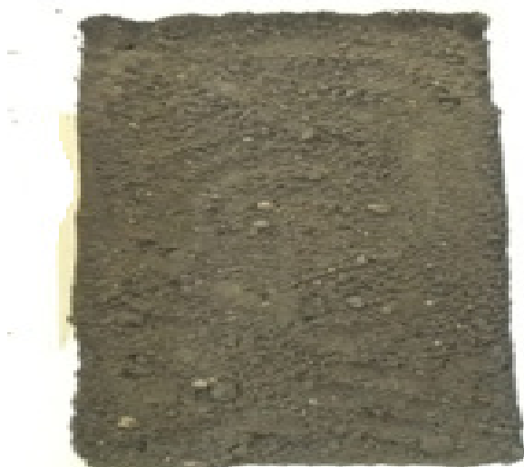
Figura 11 – Amostras de solo na bandeja de preparação (a) e após a contaminação com soluções de BTEX ou gasolina (b).
