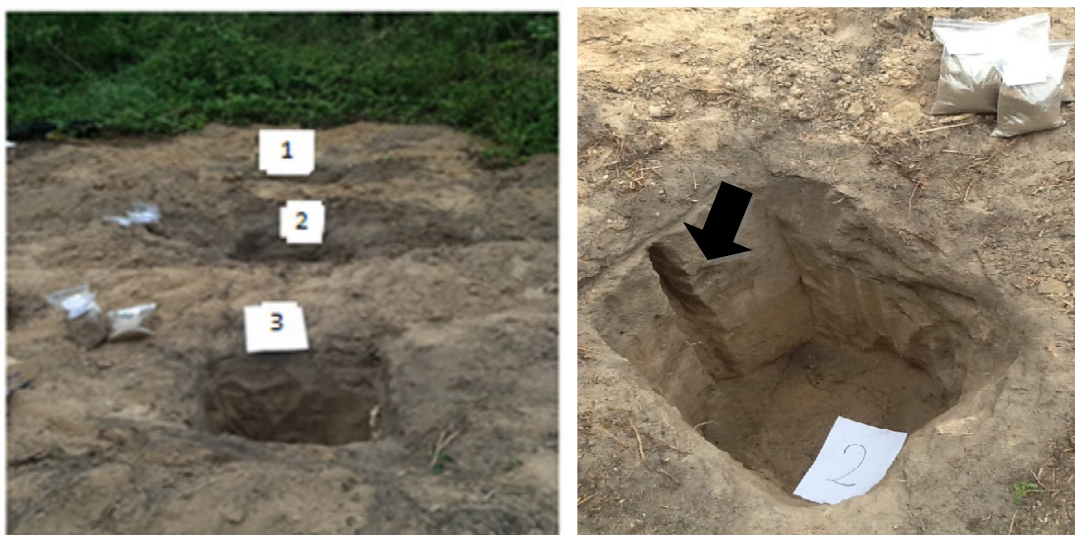
Figura 8 – Esquema de coleta das amostras. a) Poços de 1m 3 representados pelos números (1, 2 e 3) e b) Ranhura de onde foi coletada a massa de solo.
