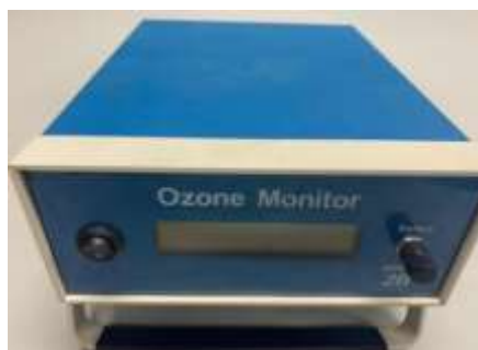
Figura 4 – Monitor de ozônio usados no monitoramento atmosférico na área em estudo.
