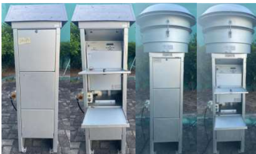
Figura 3 – Amostradores Hivol HVS 3000® para coleta dos particulados: PTS, MP_{10} e MP_{2,5} .
