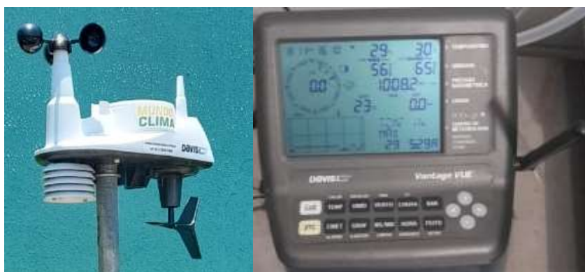
Figura 2 – Estação meteorológica usada nos estudos de monitoramento.
