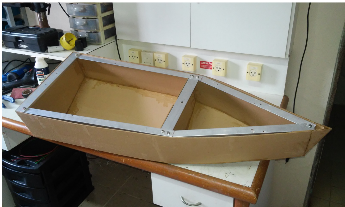
Figura 12: Estrutura do Barco em papelão.
