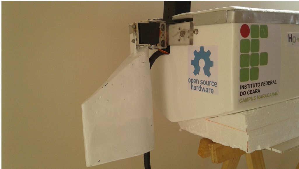
Figura 21: Leme acoplado ao servo RDS3115-MG.
