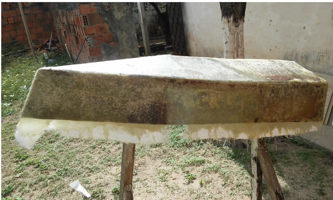
Figura 13: Laminação do Barco em fibra de Vidro.
