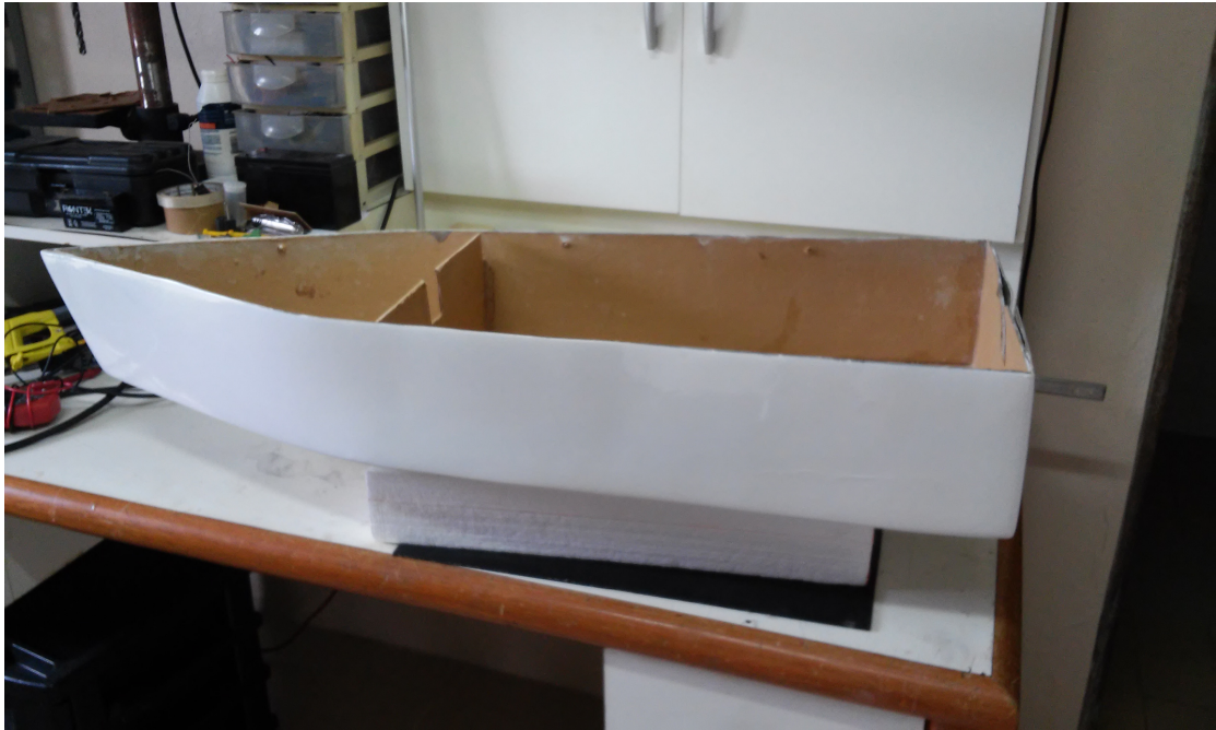
Figura 14: Estrutura do Barco em fibra de Vidro.
