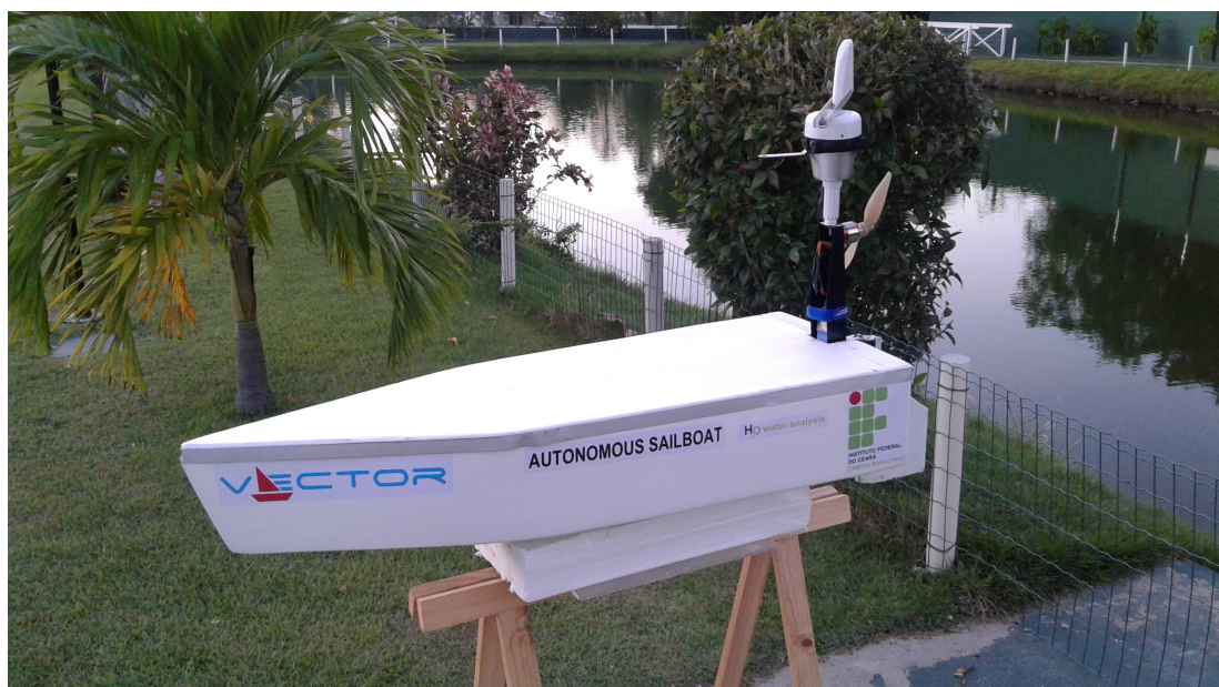
Figura 36: Barco montado no suporte de madeira para testes em lagoas.
