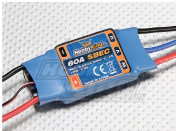
Figura 24: Controlador Eletrônico de Velocidade.
