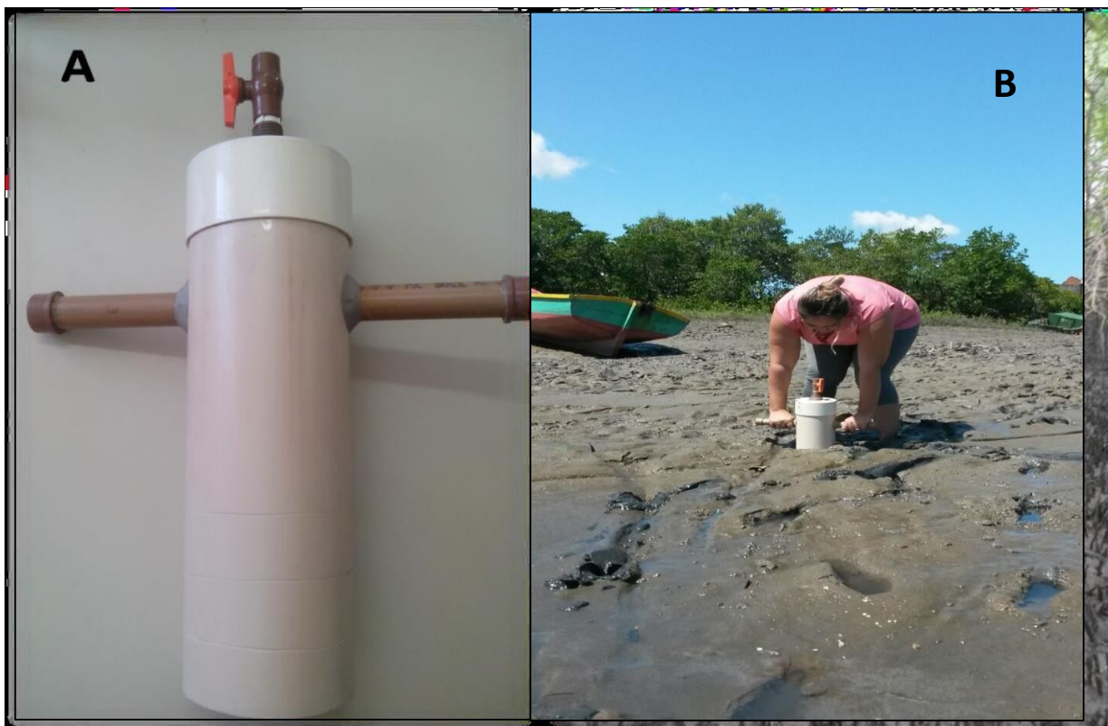
Figura 5: Amostrador cilíndrico de PVC – core (A). Coleta de sedimento em campo (B).
