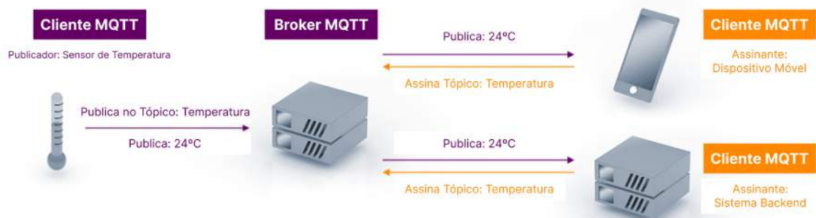
Figura 2 – Arquitetura Publicação/Assinatura do MQTT.
