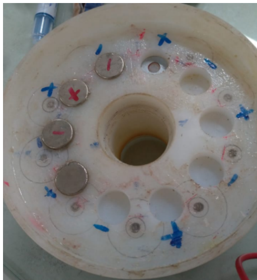
Figura 33 – Ímãs de Neodímio no rebaixo usinado
