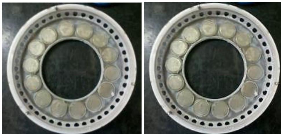
Figura 18 – Peças do rotor do gerador Enersud
