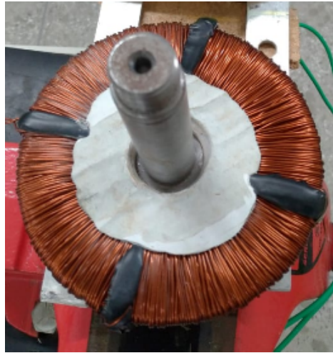
Figura 36 – Bobina Toroidal montada no eixo do gerador
