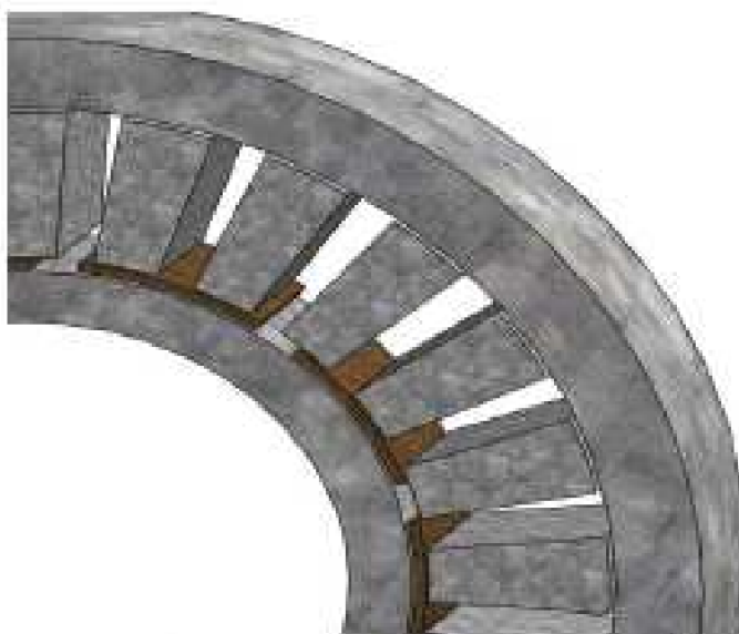
Figura 17 – Máquina completa, detalhe de ímãs, ranhuras e dentes
