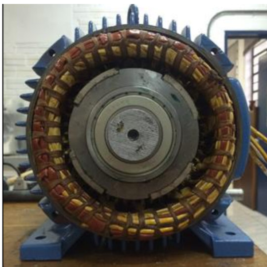
Figura 24 – Vista frontal da montagem do rotor e estator
