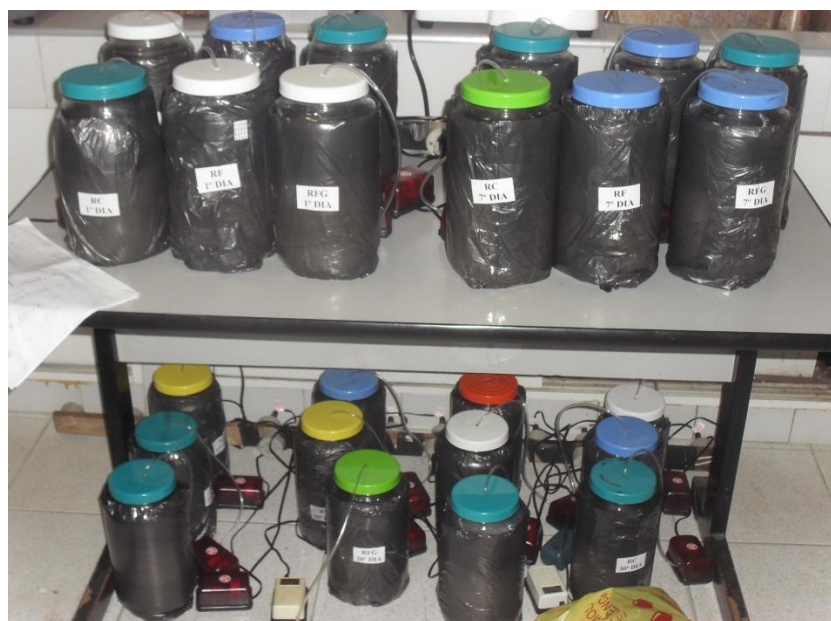
Figura 7 – Reatores em batelada aerada com biomassa dispersa de Aspergillus niger AN400.
