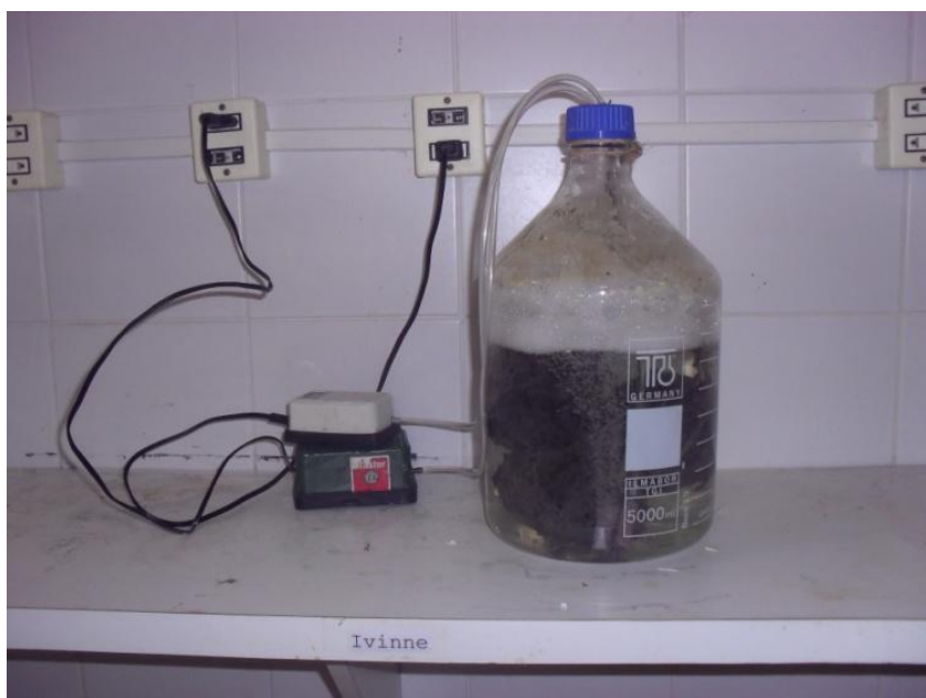
Figura 8 – Imobilização da biomassa fúngica dentro do reator. Fonte: Autor (2012).
