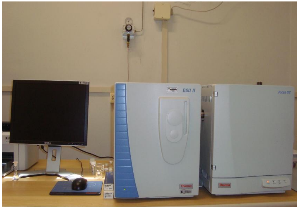
Figura 14 - Cromatógrafo a gás acoplado a espectrômetro de massa usado na quantificação dos pesticidas organoclorados.
