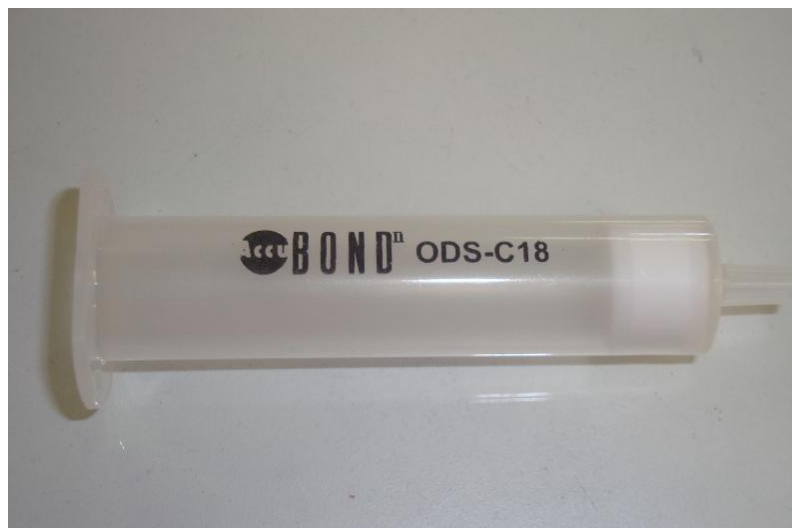
Figura 13 – Cartucho SPE-C18 usado nas etapas de concentração e purificação das amostras.
