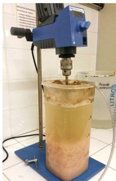
Figura 3 – Sistema RBS aeróbio onde foi cultivado o lodo de inóculo
