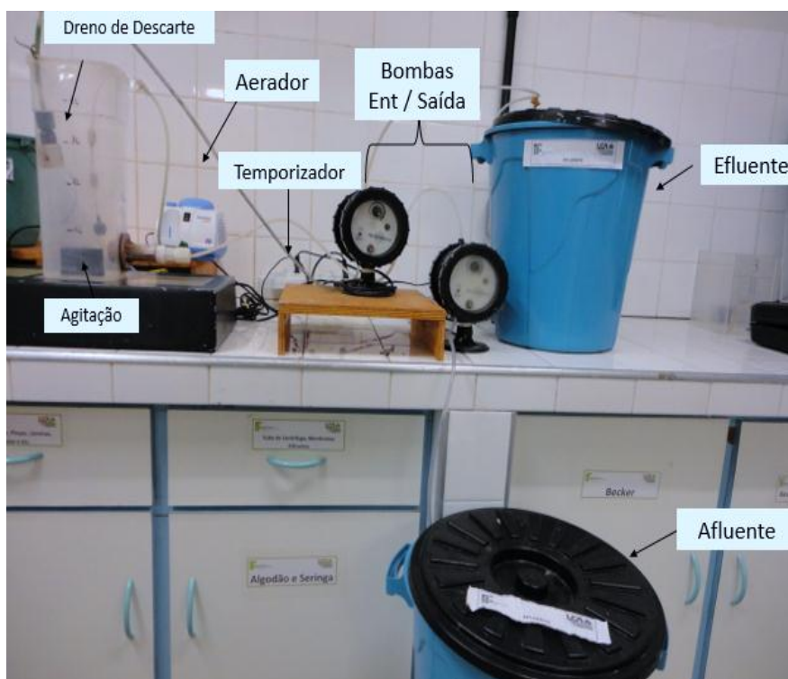
Figura 6 – Sistema RBS 1 com seus respectivos componentes
