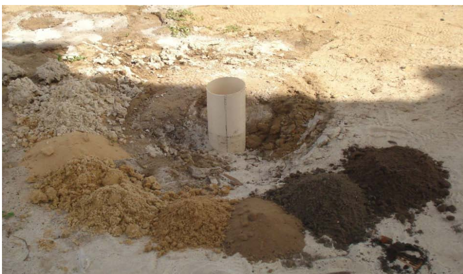
Figura 22 – Poço 2 construído para a determinação da condutividade hidráulica.
