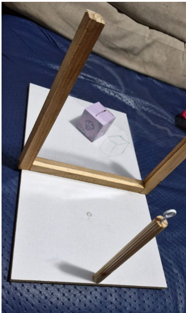
Figura 6.30 – Protótipo da Máquina de Dürer produzida pelos autores
