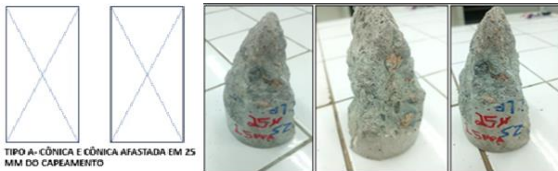
Figura 16 - Rompimento do CP 9 do concreto com 25% de CIRSP
