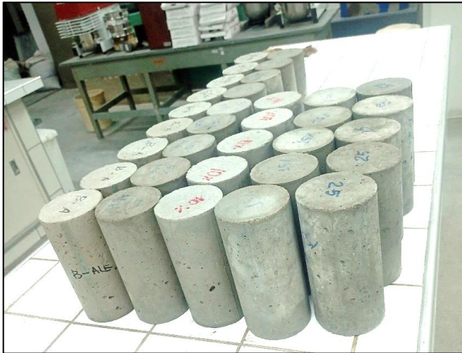
Figura 5 - Exemplos dos corpos de prova elaborados na pesquisa
