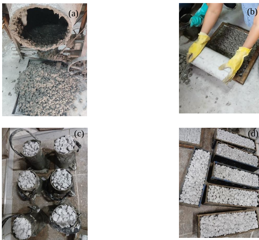
Figura 12 — Mistura dos materiais na betoneira (a), Moldagens das placas (b), corpos-de-prova cilíndricos (c) e prismáticos (d)
