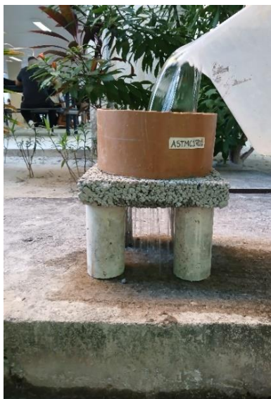
Figura 16 — Ensaio de determinação do coeficiente de permeabilidade (k) na placa de concreto permeável.
