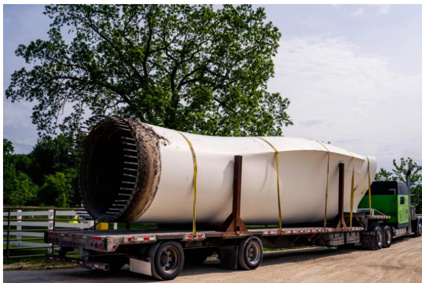
Figura 54 – Pá eólica cortada para transporte para unidade de tratamento.
