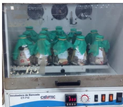
Figura 17 - Incubadora de bancada CT -712 com agitadores rotatórios
