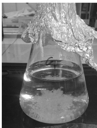
Figura 26- Formação de “ pellets ” nos reatores em bateladas agitadas inoculados com Aspergillus niger AN400
