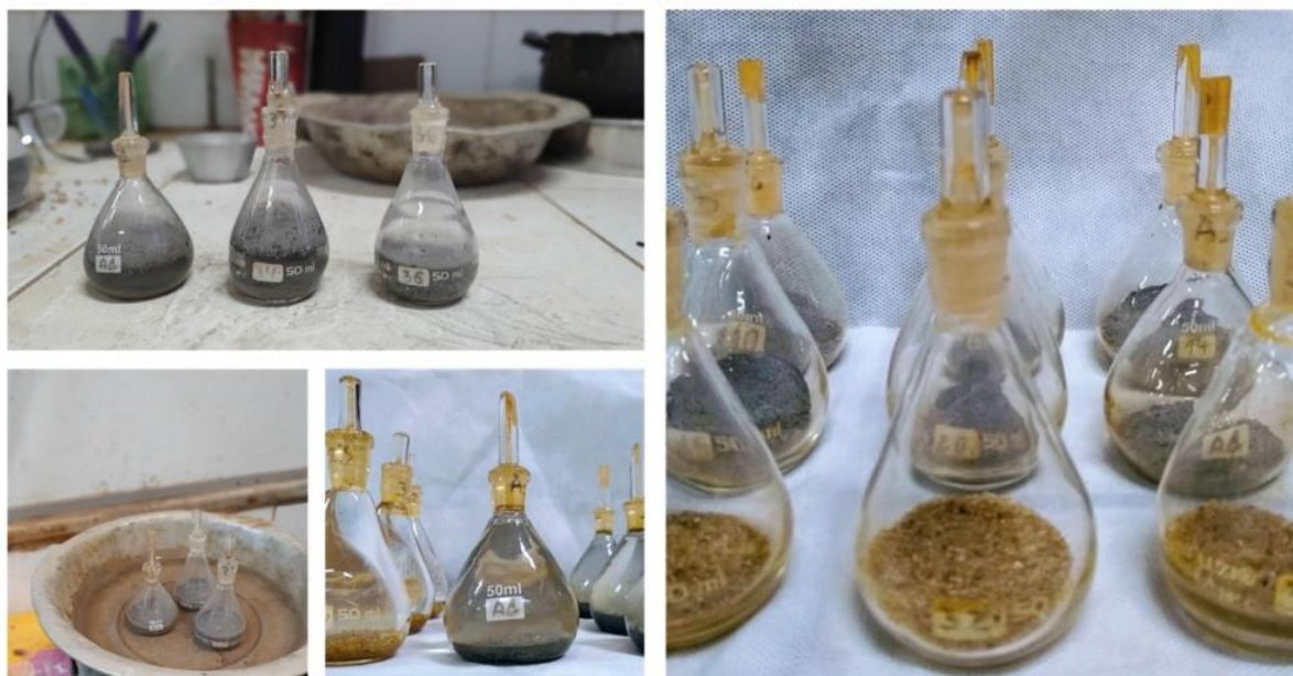
Figura 17 - Imagens do ensaio para determinação da densidade real
