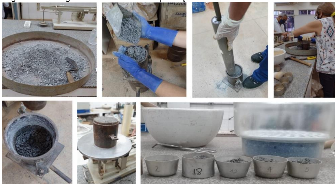
Figura 16 - Imagens do ensaio de compactação
