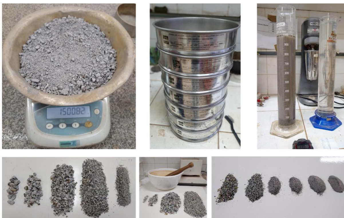
Figura 13 - Imagens do ensaio de granulometria
