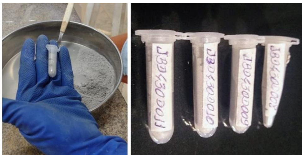
Figura 8 - Eppendorfs com amostras de cinzas de RSP para análise FRX e DRX
