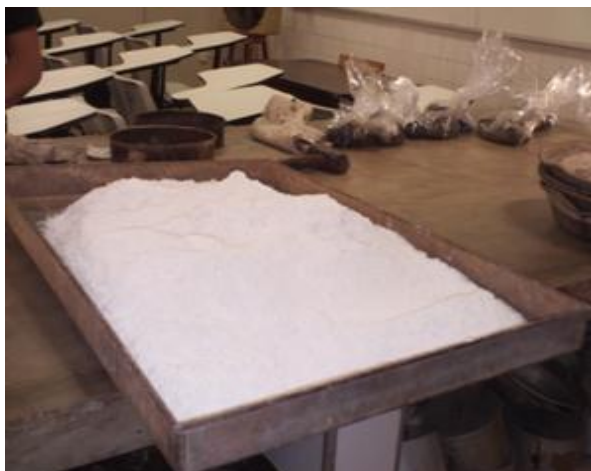
Figura 25 – Resíduo de gesso após moagem em equipamento de Abrasão Los Angeles e peneiramento (2 mm).
