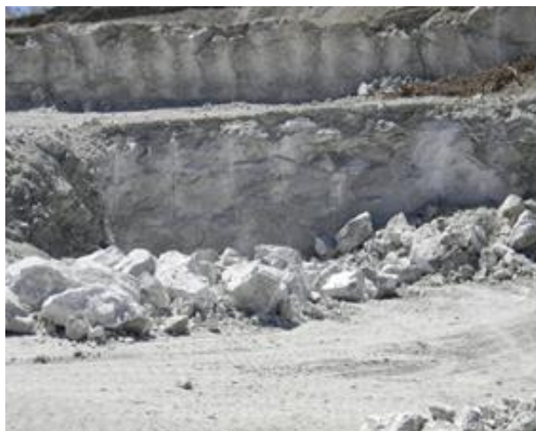
Figura 3 - Desmonte secundário e terciário da bancada da Mina Pedra Branca visitada em julho de 2012.
