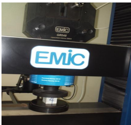
Figura 32 – Máquina universal de ensaios utilizada nos experimentos.
