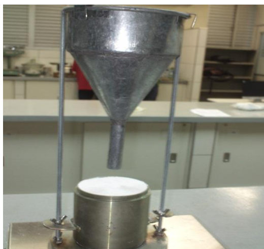
Figura 27– Aparelho para determinação da massa unitária.
