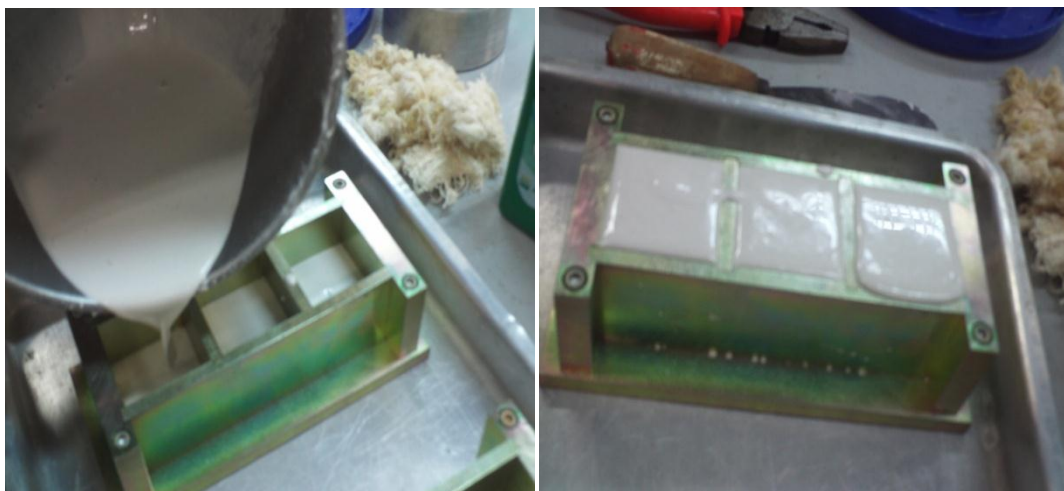
Figura 31 – Preparação e moldagem dos corpos de prova.
