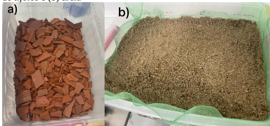
Figura 3— Substratos utilizados na camada de base (a) fragmentos de tijolos e (b) areia
