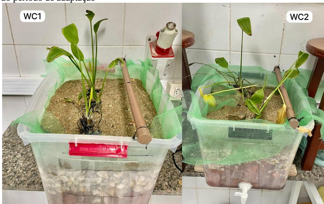
Figura 29—Visualização das macrófitas Echinodorus subalatus vegetando os wetlands construídos (WC1: com camada de concha inteira; WC2: com camada de concha triturada) em escala de bancada na segunda semana do período de adaptação
