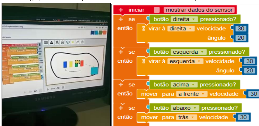
Figura 22 – Código para movimentação de um robô utilizando o teclado do computador com alunos do Ceará
