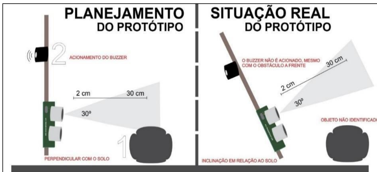
Figura 35 – Protótipo idealizado x Protótipo funcionando em ambiente real
