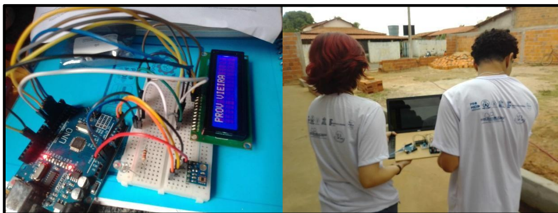
Figura 44 – Protótipo para medir a intensidade da radiação UV e momento da medição
