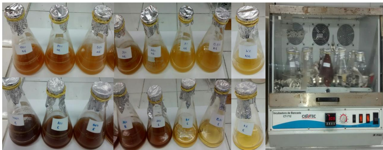
Figura 10- Produção de inóculo adaptado a partir de cultivo em manipueira, em meio não esterilizado (NE) e esterilizado (E), nas concentrações de 0,5%, 1%, 5%, 20%, 30%, 50%, 80% e 100% v/v.
