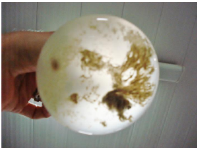
Figura 25 – Crescimento microbiano no reator com efluente contendo 5% da solução estoque e 3,0 g/L de glicose.
