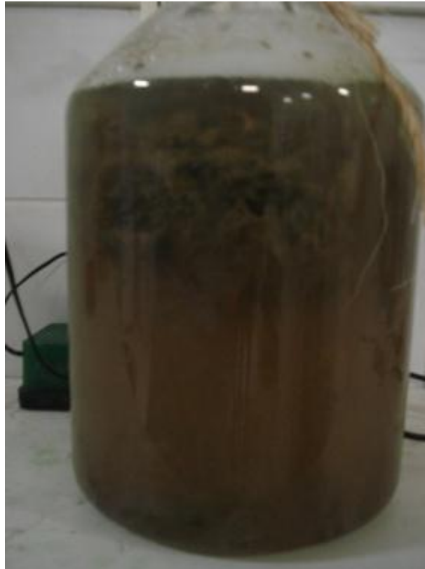
Figura 31 – Reator em batelada sequencial no momento da partida do ciclo três para a degradação biológica com biomassa imobilizada.
