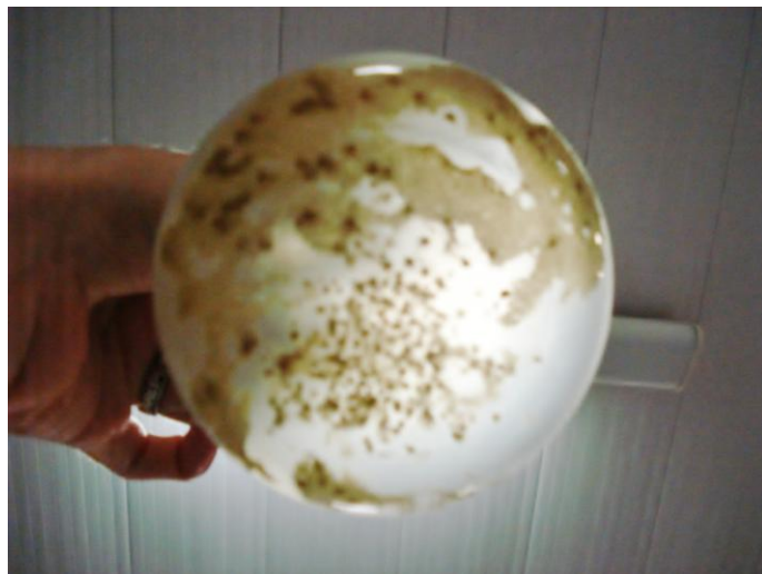
Figura 24 – Crescimento microbiano no reator com efluente contendo 5% da solução estoque e 1,0 g/L de glicose.
