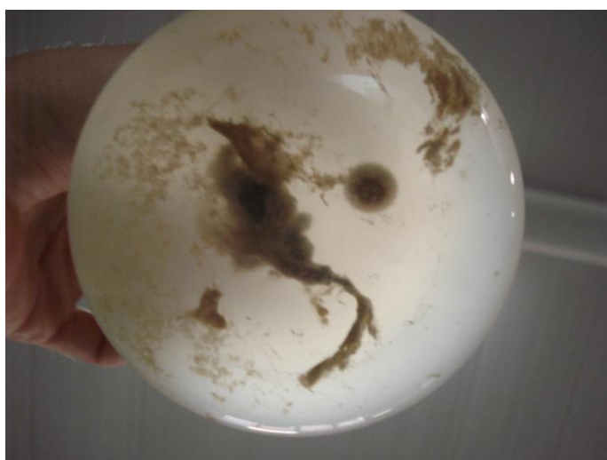
Figura 26 – Crescimento microbiano no reator com efluente contendo 2% da solução estoque e 0,5 g/L de glicose.
