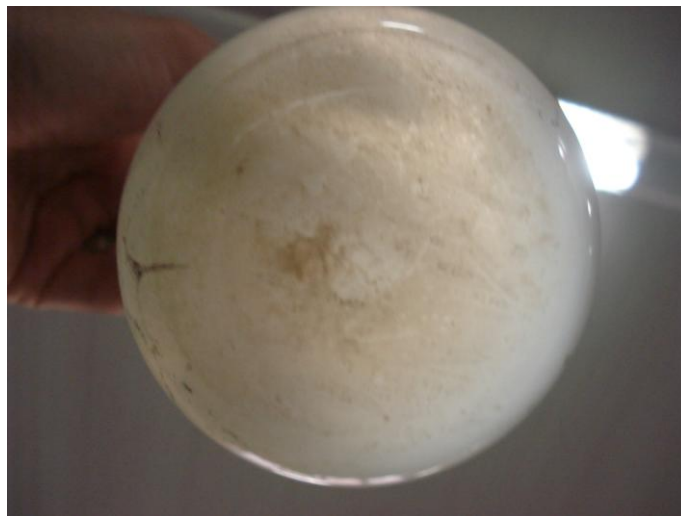
Figura 20 – Crescimento microbiano no reator controle com efluente contendo 5% da solução estoque.
