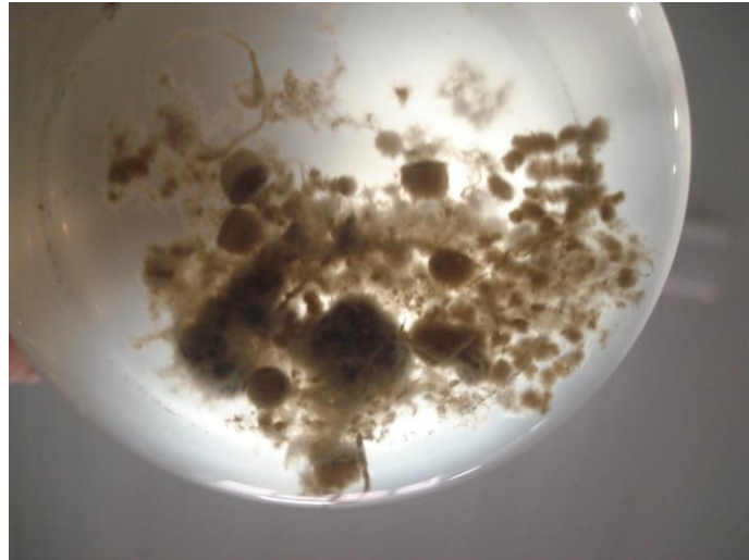
Figura 23 – Crescimento microbiano no reator com efluente contendo 5% da solução estoque e 0,5 g/L de glicose.
