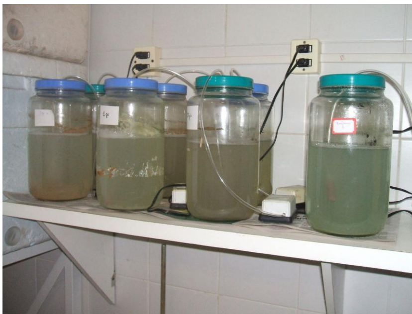
Figura 3 – Reatores em batelada com biomassa dispersa sob aeração a temperatura ambiente a 27 °C.
