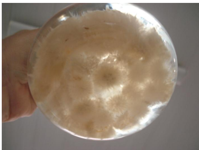
Figura 28 – Crescimento microbiano no reator com efluente contendo 2% da solução estoque e 3,0 g/L de glicose.
