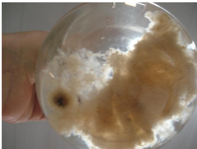
Figura 27 – Crescimento microbiano no reator com efluente contendo 2% da solução estoque e 1,0 g/L de glicose.
