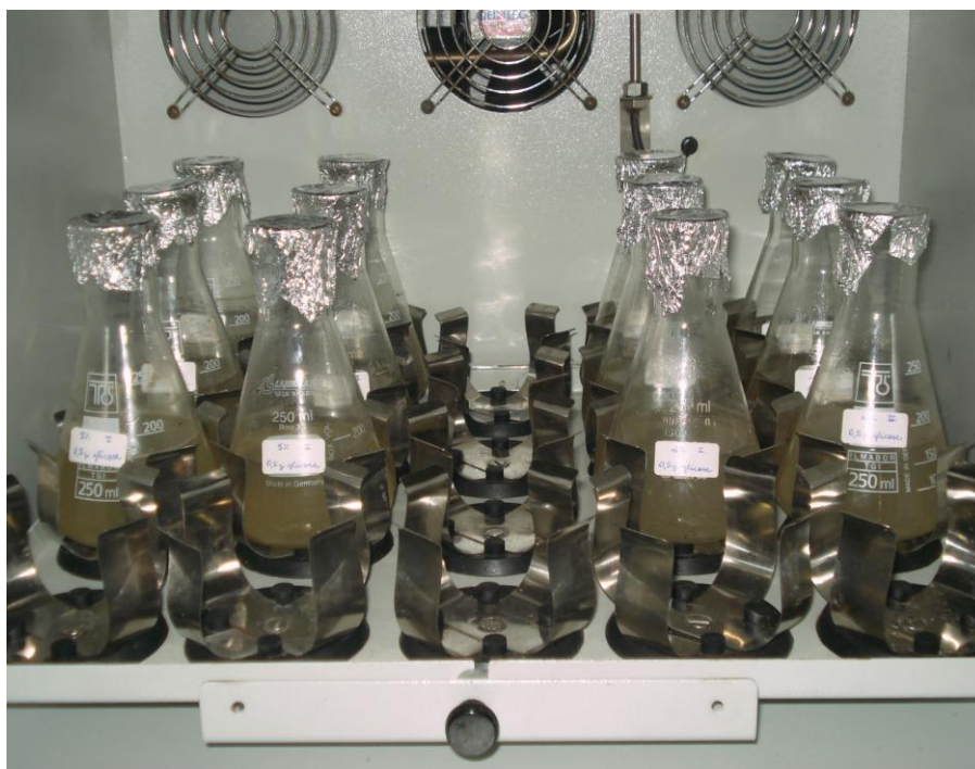
Figura 4 – Reatores em batelada dispostos sobre mesa agitadora a 27 °C.
