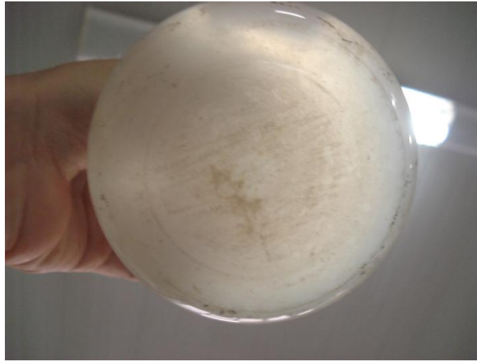
Figura 19 – Crescimento microbiano no reator controle com efluente contendo 2% da solução estoque.
