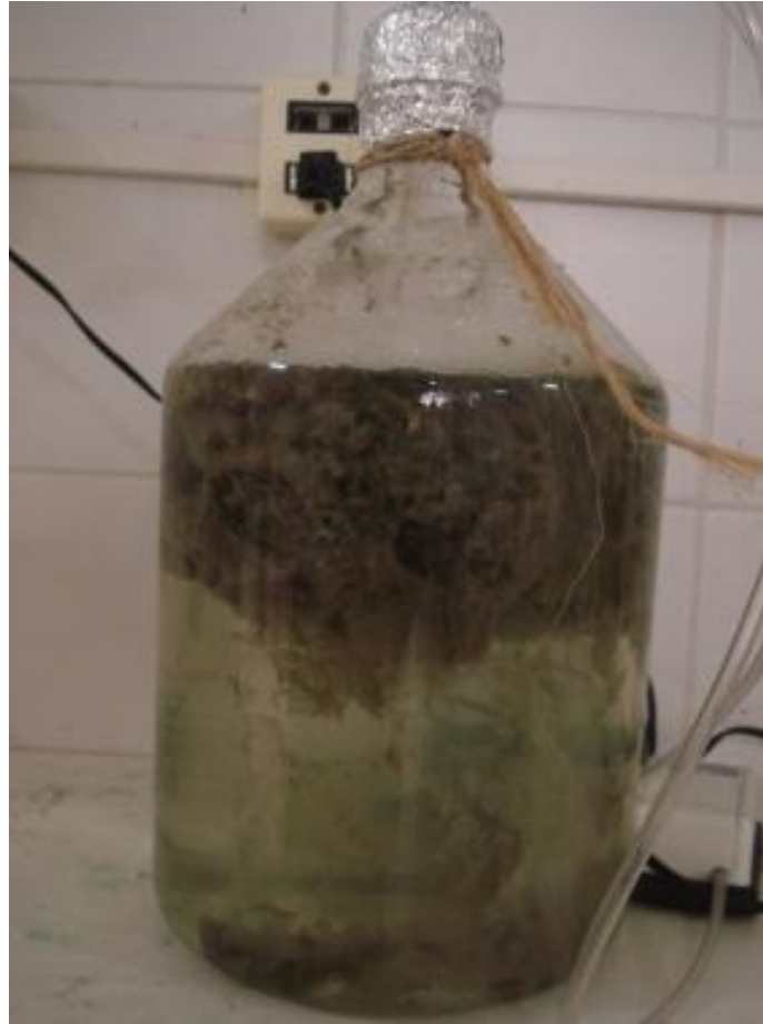
Figura 5 – Reator em batelada seqüencial com biomassa imobilizada sob aeração a 27 °C.
