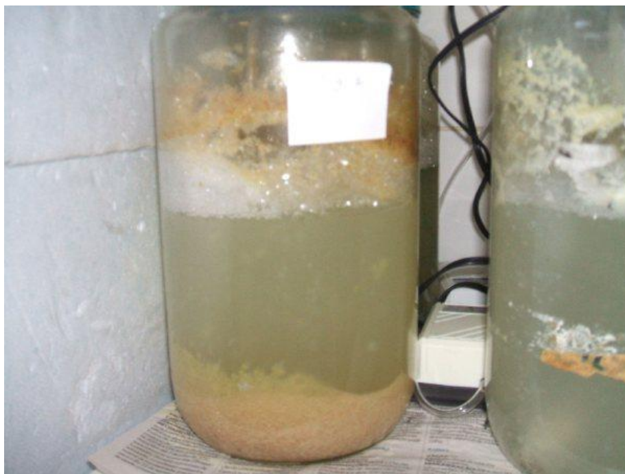
Figura 12 – Reator com concentração de glicose de 3 g/L aos 7 dias de reação com formação de biofilme aderido.
