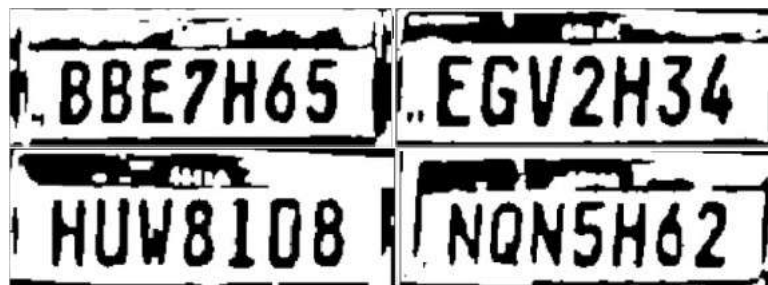
Figura 13 – Ilustração da etapa de pré-processamento: As imagens passam por operações de suavização, binarização e operações morfológicas.
