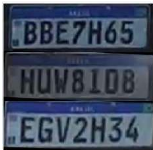
Figura 12 – Ilustração do estágio de ajuste de perspectiva: novas imagens geradas pela correção de inclinação das placas.
